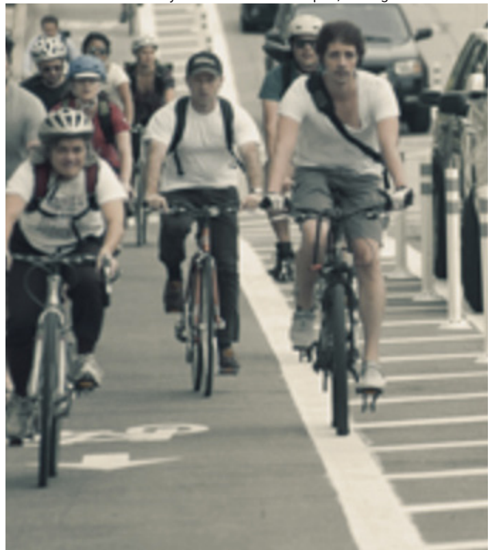
Piste cyclable avec zone tampon, Chicago. Photo: CDOT
